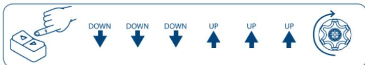
Après la séquence le moteur bougera en mode "Homme présent" pour permettre un réglage précis de la position intermédiaire désirée. Pour mémoriser la position choisie confirmer avec la séquence suivante:
